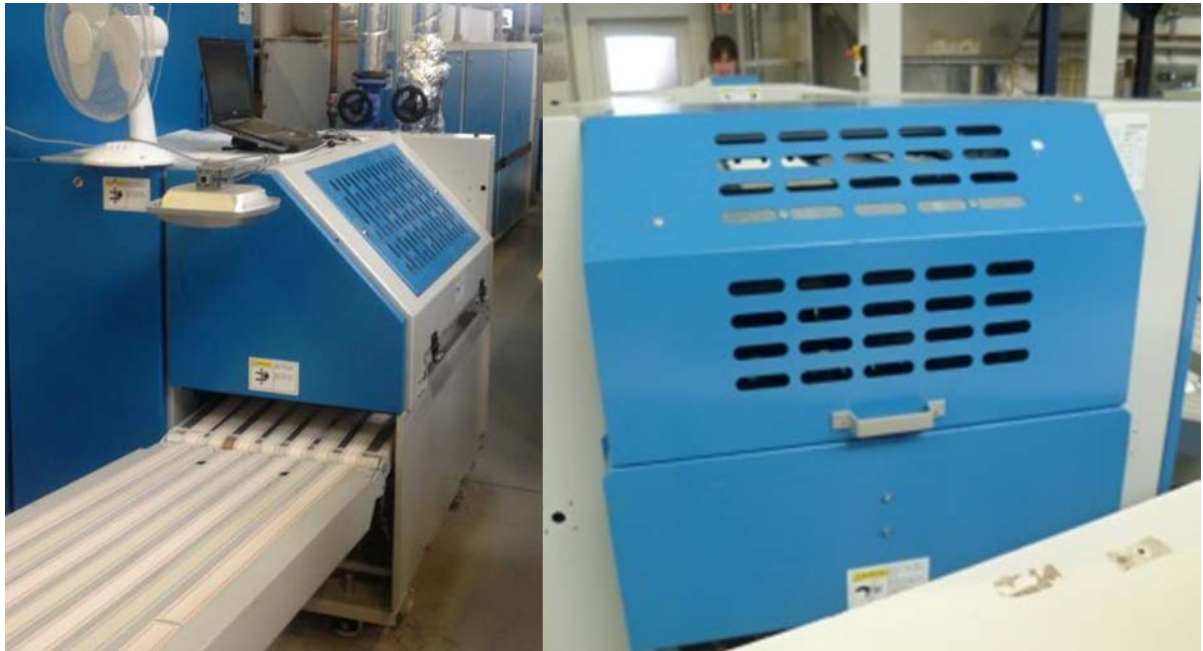
Abbildung 28: Installation der Leser an den Falt-/Stapelmaschinen, links: außerhalb der Maschine, rechts: innerhalb der Maschine
