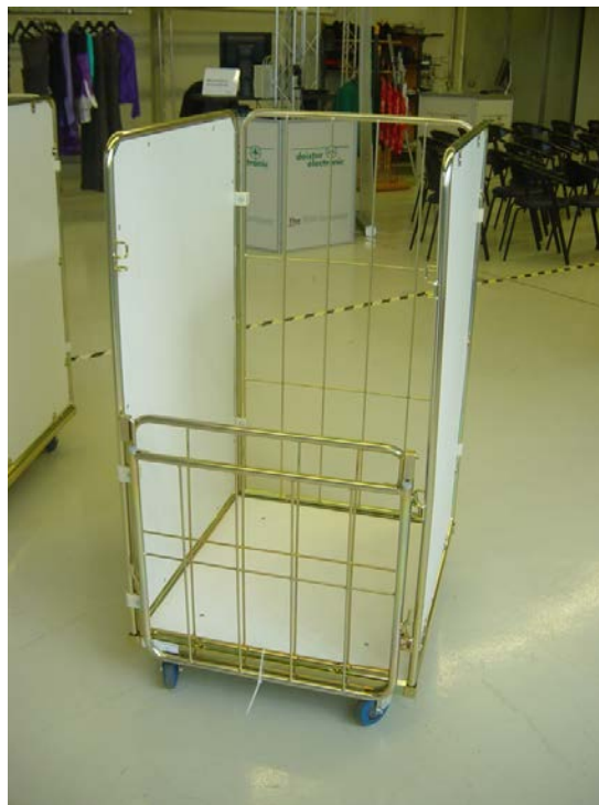
Abbildung 8: Gittercontainer Typ Junior 1.510 : Seitenteile und Boden mit Kunststoffplatten ausgekleidet
