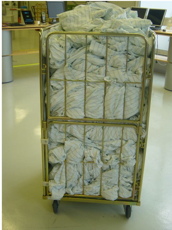
Abbildung 9: Gittercontainer Typ Junior 1.510 : Komplett mit Draht am Korpus (kein Kunststoff verwendet)
