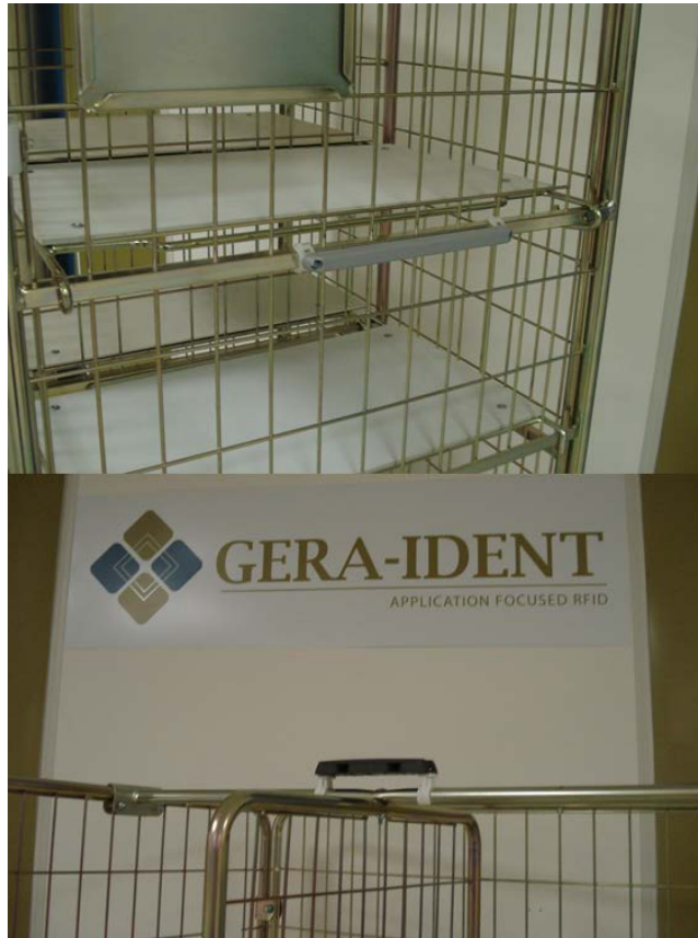
Abbildung 12: Unterschiedliche Anbringung der Transponder an dem Container Typ „Altenheim“, oben: Anbringung seitlich, unten: Anbringung oben
