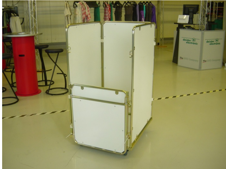
Abbildung 7: Gittercontainer Typ Junior 1.510: Alle Seiten, Rückwand, Boden sowie Vorderwand sind mit Kunststoffplatten ausgekleidet
